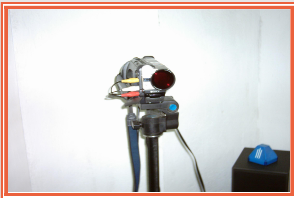
Cámara sensible preparada para detectar parte del espectro no visible al ojo humano.
